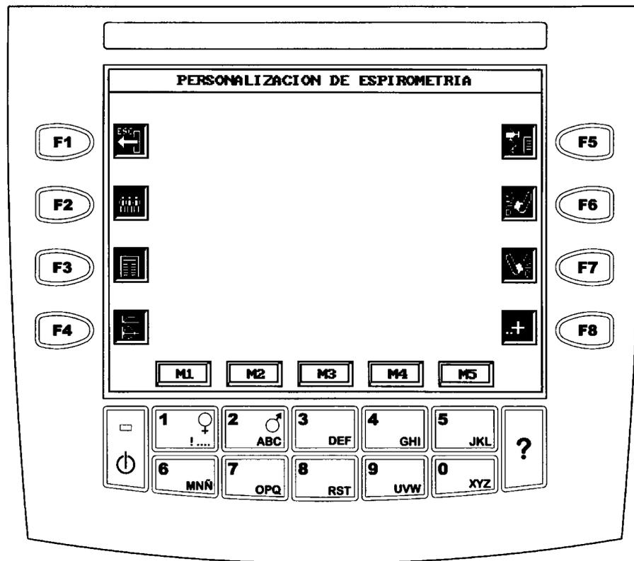
Tutte le funzioni sono accessibili tramite le otto chiavi, da F1 a F8, posizionate sulla parte a sinistra (da F1 a F4) e sulla parte destra (da F5 a F8) del display.
