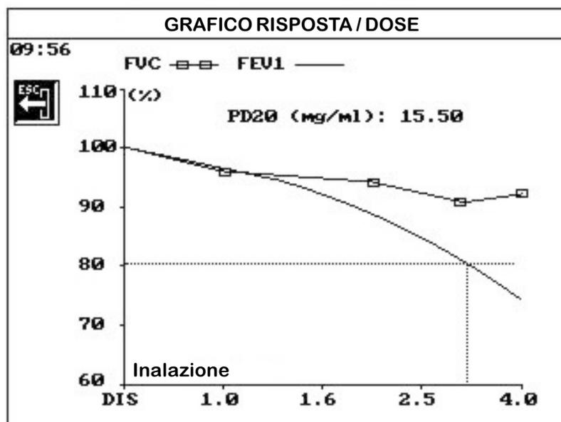
Il grafico dose/risposta viene mostrato matematicamente aggiustato tramite un procedimento di aggiustamento logaritmico ( $y = C1 + C2 \log(x)$ ) se il coefficiente di determinazione è migliore dell'80%. In questo caso, il calcolo della PD20 viene fatto risolvere nella equazione di aggiustamento. Se il coefficiente di determinazione è inferiore all'80%, il grafico viene presentato linearmente ed il calcolo della PD20 viene fatto per interpolazione lineare.
